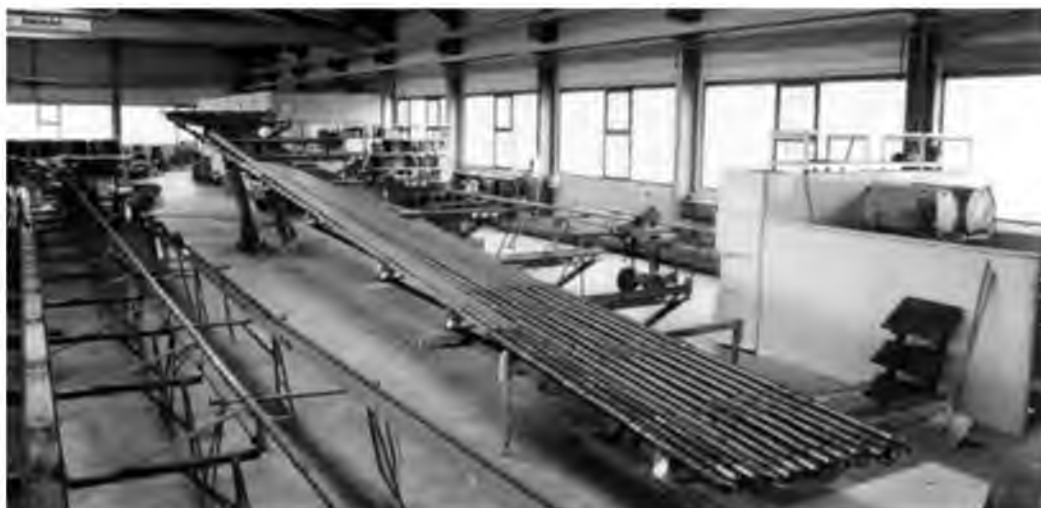
Рисунок 10.7 - Комплектация конструкции анкера на наклонном стенде *
