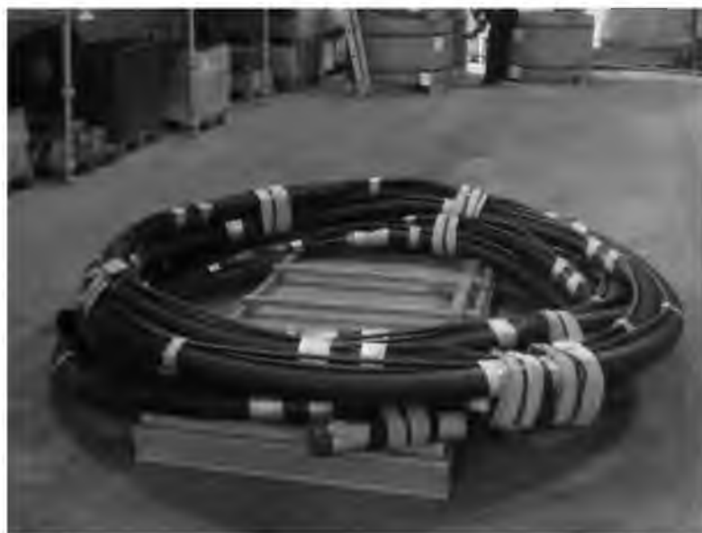
Рисунок 10.5 – Анкер из арматурных канатов в гофрированной трубе-оболочке в транспортном положении
